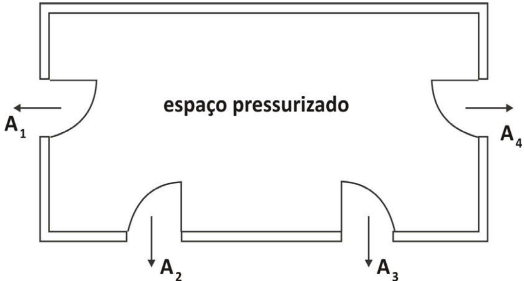
Figura 1 - Trajetórias de escape do ar em paralelo
