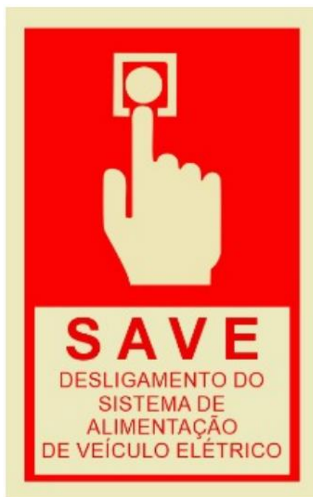
Figura 4: Exemplo de sinalização do ponto de desligamento manual individual do SAVE (dimensão mínima de 200 mm de largura e 400 mm de altura).
