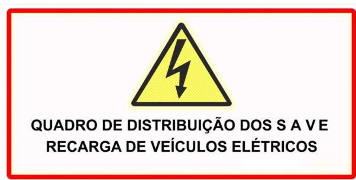
Figura 7: Exemplo de sinalização para a identificação dos quadros elétricos dos SAVES (dimensão mínima de 400 mm de largura e 200 mm de altura).
