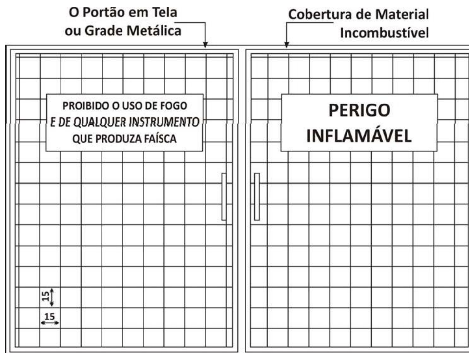
Figura 4C – Vista frontal da central de GLP.
