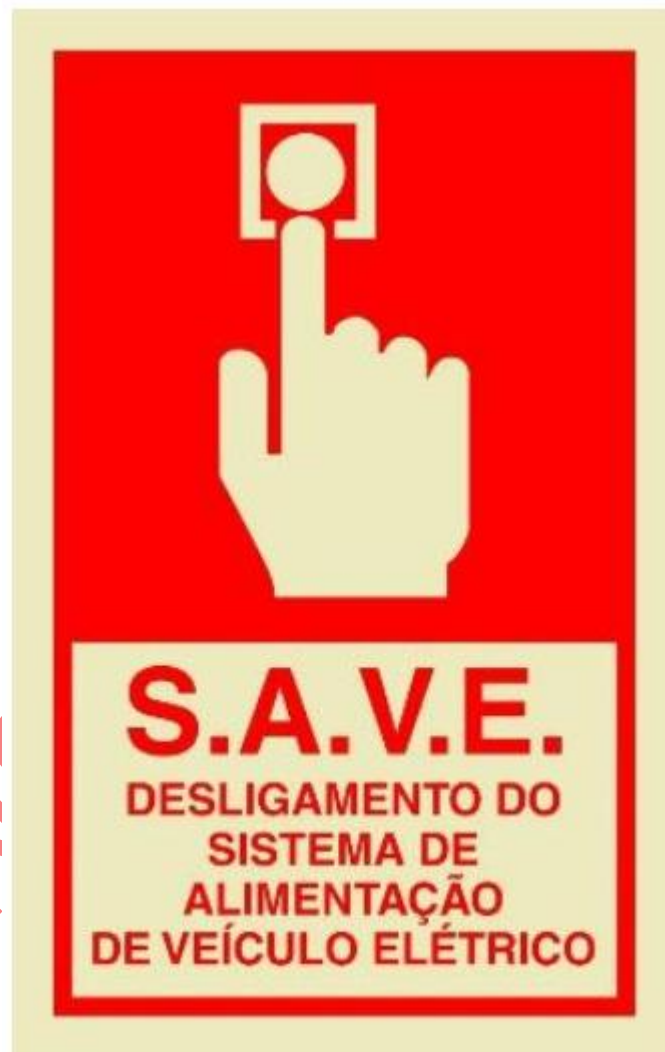
Figura 4: Modelo de placa de sinalização de emergência referente ao ponto de desligamento manual do SAVE.
