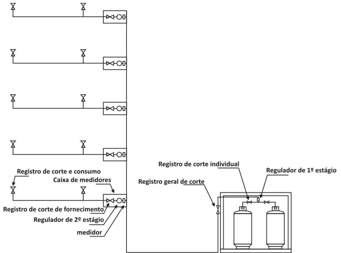
Figura 5 – Isométrico da tubulação da central de GLP.
