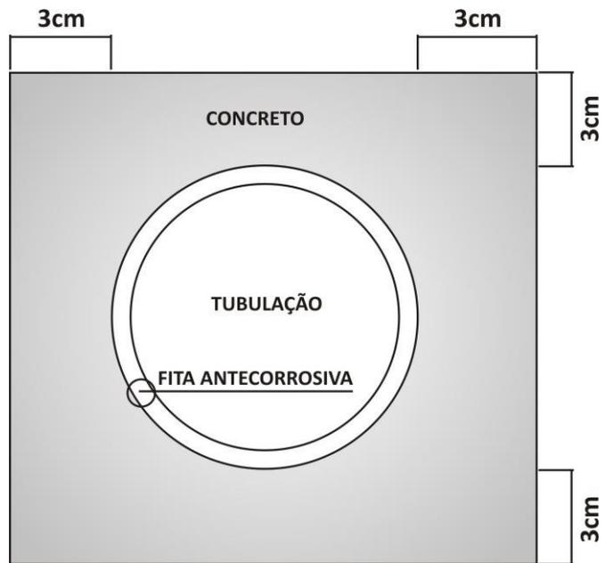
Figura 2 – Detalhe de envelopamento da tubulação
