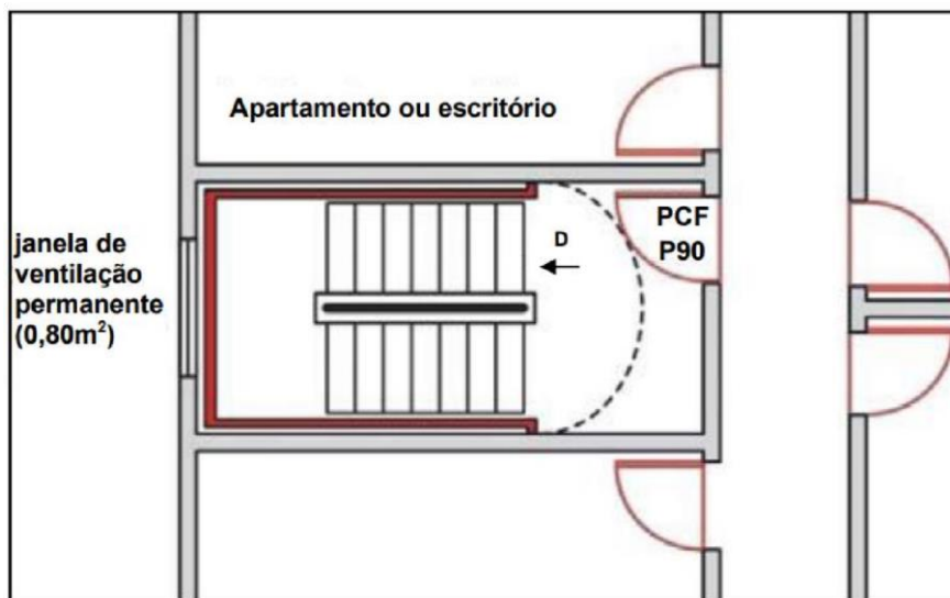
Figura 7 – Escada enclausurada protegida
