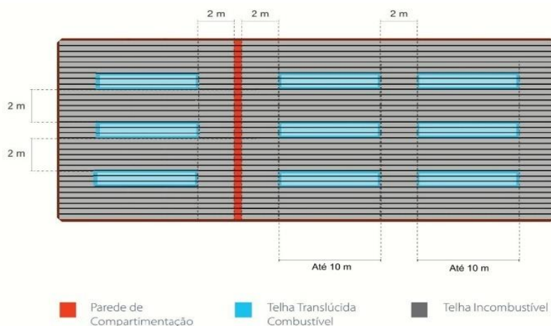
Figura 2: Afastamento de telhas combustíveis translúcidas
