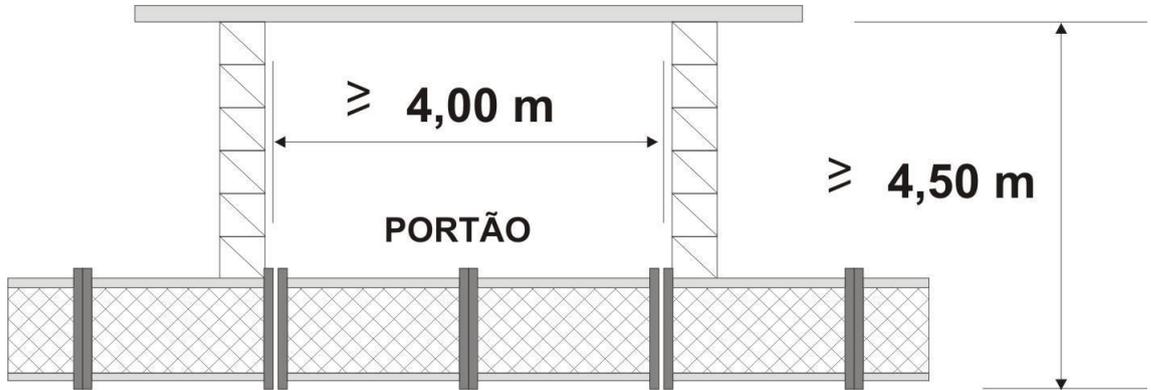
Figura 1 – Altura e largura mínimas de acesso à edificação
