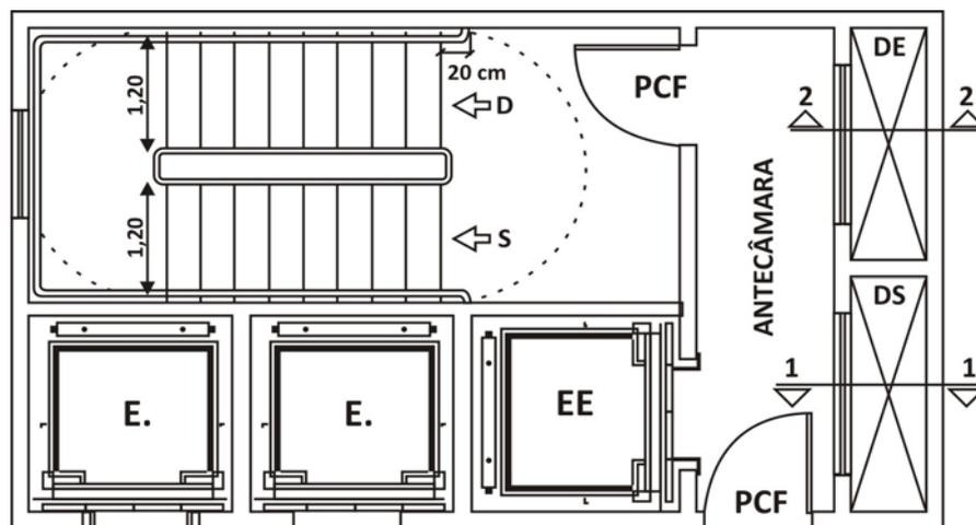
Figura 10 – Escada enclausurada à prova de fumaça, com elevador de emergência (posição exemplificativa) na antecâmara.
