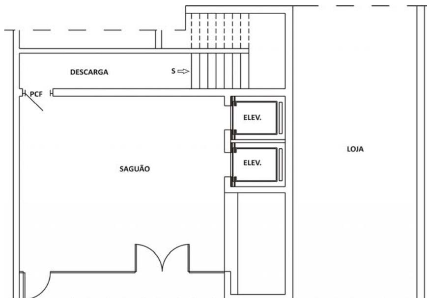
Figura 20 – Descarga através de hall térreo não enclausurado
