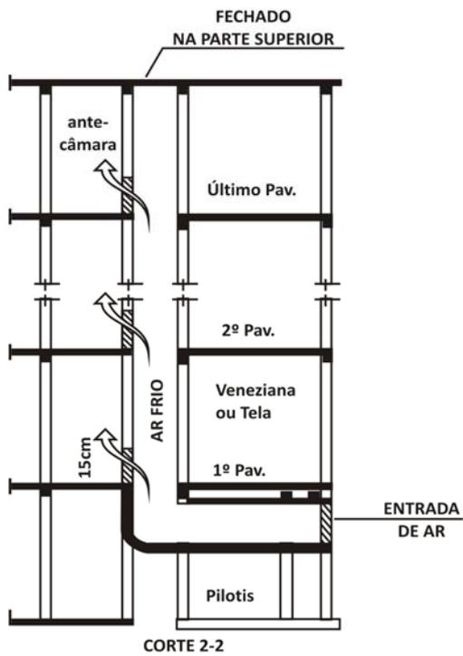
Figura 11 – Duto de ar – Desenho esquemático (ver figura 10)
