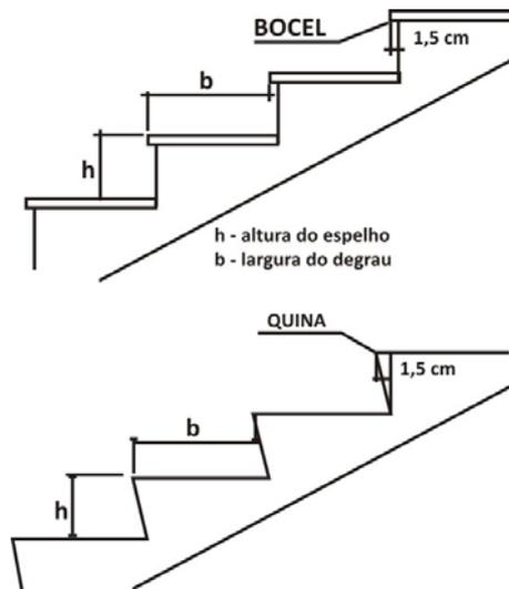
Figura 4 – Altura e largura dos degraus (escada com ou sem bocel)
