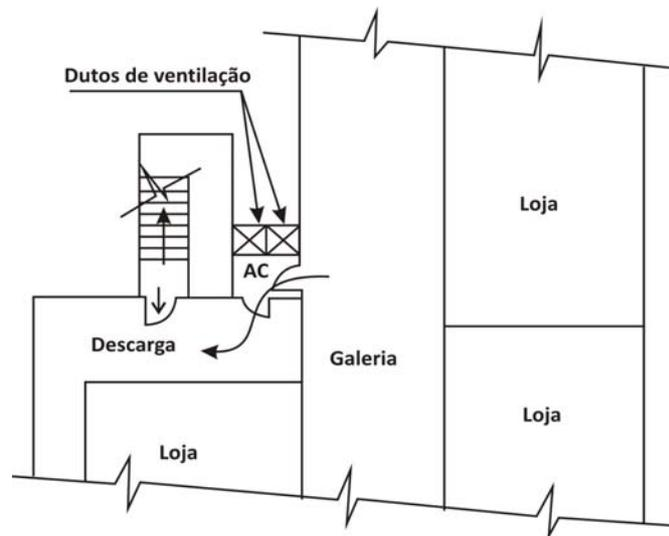
Figura 22 – Acesso de galeria comercial à descarga
