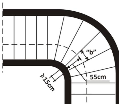
Figura 5 – Escada com lanços curvos e degraus balanceados
