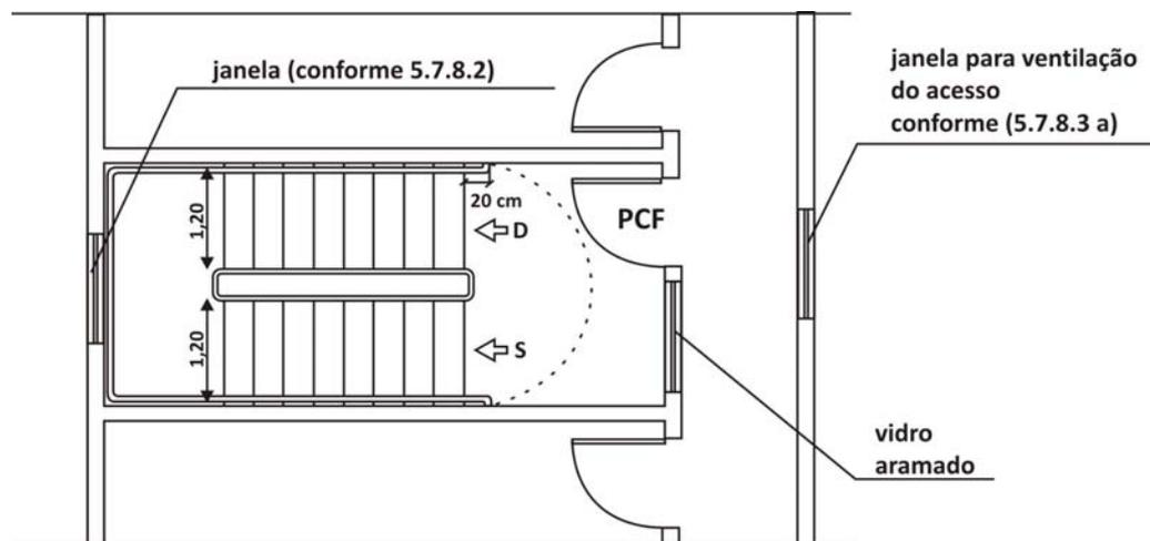
Figura 9 - Ventilação da escada enclausurada protegida e seu acesso
