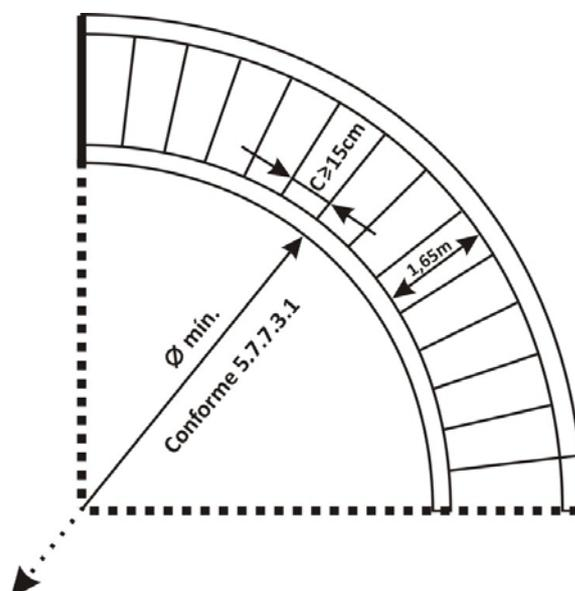
Figura 7 – Escada curva admissível como saída de emergência
