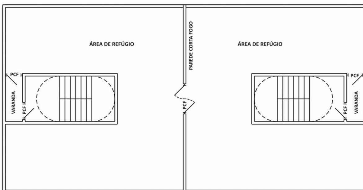
Figura 19 – Desenho esquemático da área de refúgio
