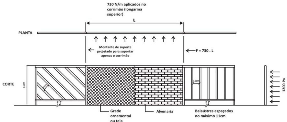
Figura 18 – Pormenores construtivos de instalação de guardas e cargas a que elas devem resistir
