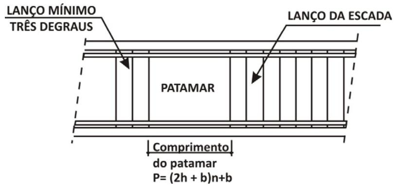
Figura 6 – Lanço mínimo e comprimento dos patamares
