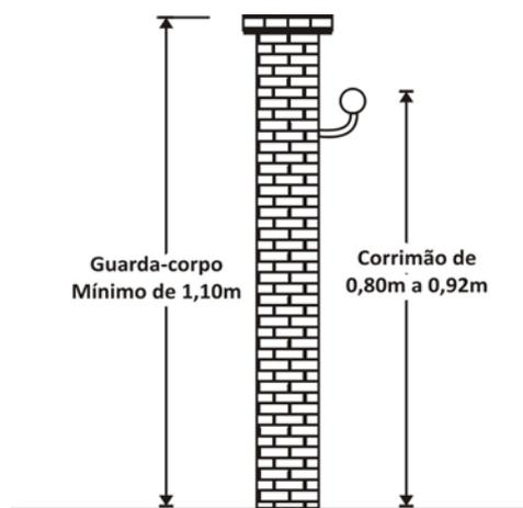
Figura 15 – Dimensões de guardas e corrimãos
