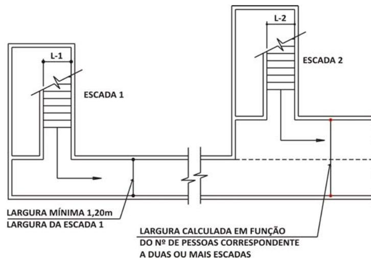
Figura 21 – Dimensionamento de corredores de descarga
